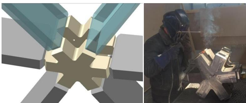
Рис. 5. Коннектор сварной наборного сечения
